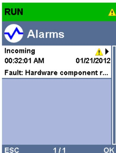
Рисунок 3-2 Отображение сообщения об ошибке на дисплее S7-1500 CPU
