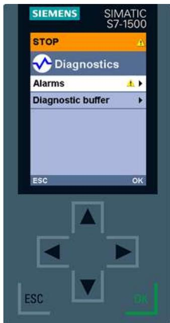
Рисунок 4-4 Дисплей - экран диагностики
