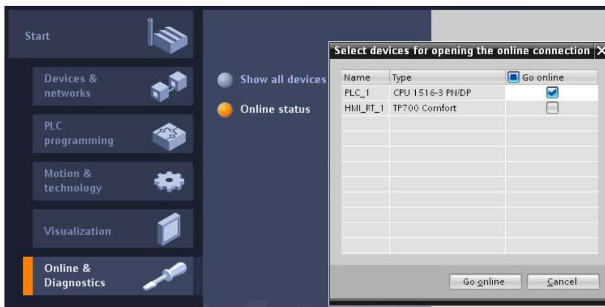
Рисунок 3-3 Выбор устройства в окне отображения портала для online-подключения.
